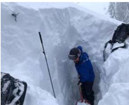
Erstellung Schneeprofil und Befüllung der Sprenganlage
